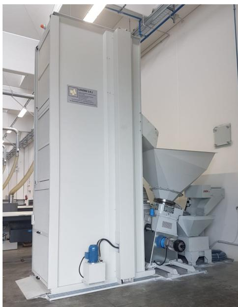
**Elevatore ribaltatore oleodinamico**
