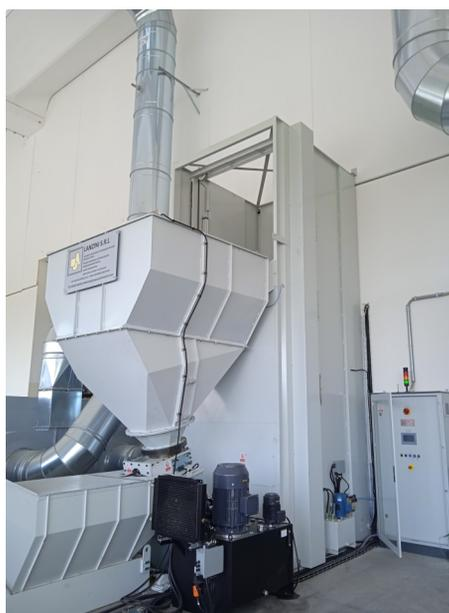
**Elevatore ribaltatore oleodinamico per scarico trucioli nel tritatore**
