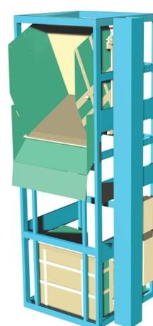
**Rendering Elevatore Ribaltatore idraulico**
